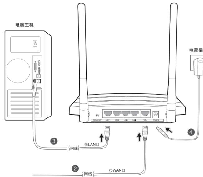
连接完成后，请检查路由器指示灯是否正常。如果指示灯显示不正常，请检查连接是否正确。
